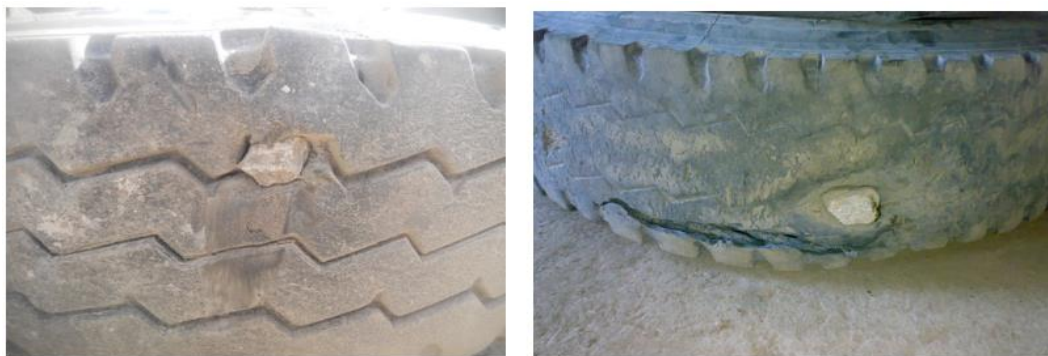
Рис. 4. Глухие проколы шин обломками твердых скальных пород
