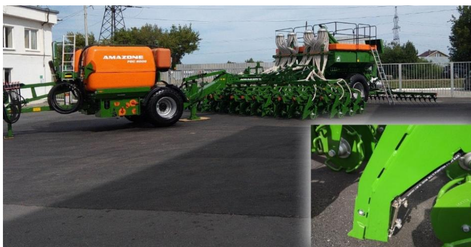
Рис. 9. Универсальный агрегат FDC 6000 с сеялкой Primera DMC 9000, оборудованной системой подачи жидких удобрений под анкерный сошник
