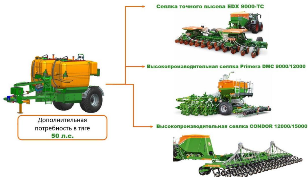
Рис. 8. Варианты агрегатирования FDC 6000 с зерновыми и пропашными сеялками АО «Евротехника»: пропашная сеялка точного высева EDX 9000-TC, зерновые сеялки для классических технологий и No-Till, Mini-Till: DMC 9000; DMC 12000; Condor 12000; Condor 15000
