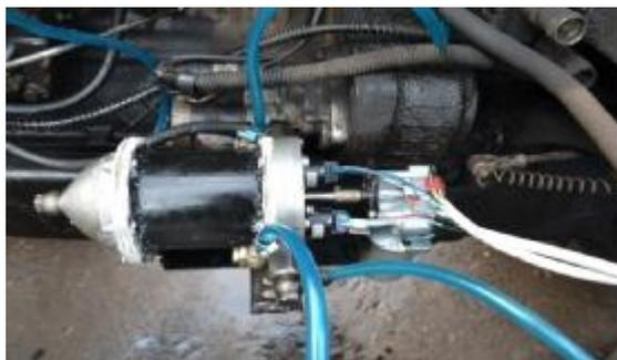
Рис. 4. Смеситель компонентов биоминерального топлива с активным приводом
