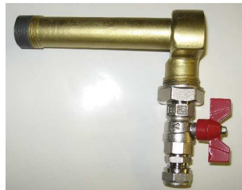
Рис. 3. Модели вихревого гидравлического теплогенератора с номинальными параметрами и минимизированными параметрами
