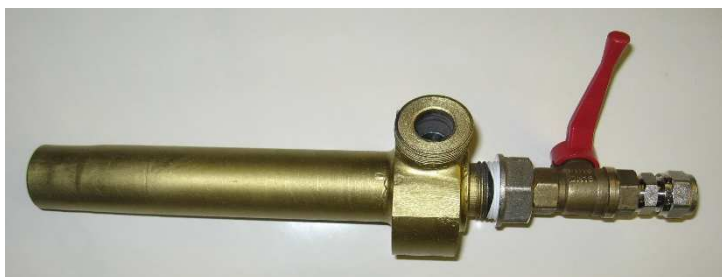
Рис. 3. Модели вихревого гидравлического теплогенератора с номинальными параметрами и минимизированными параметрами
