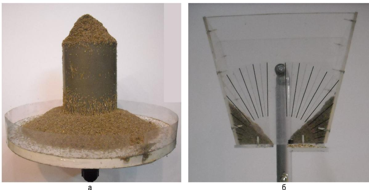
Рис. 2. Исследование сыпучести (а) и угла обрушения (б) семян мятлика лугового
