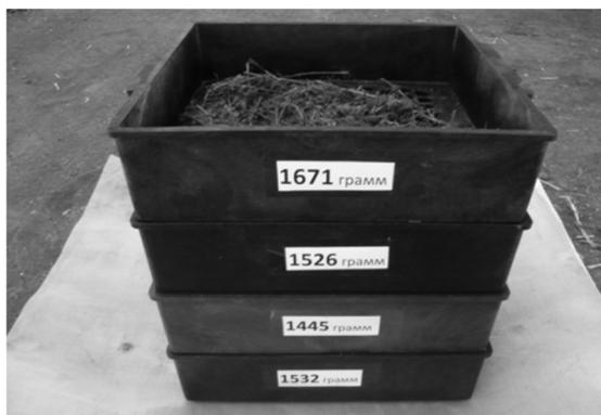
Рис. 1. Секционное сито для определения структуры кормосмеси
