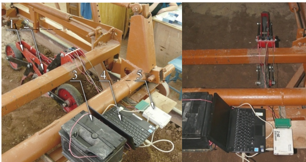
Рис. 2. Общий вид экспериментальной установки и измерительного оборудования: 1 – посевная секция; 2 – датчик; 3 – АКБ; 4 – ПК; 5 – измерительный модуль E-440
