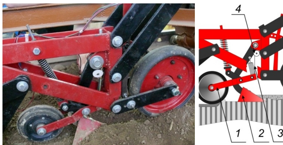
Рис. 3. Общий вид и схема крепления датчика: 1 – планка крепления бороздообразующего колеса и фиксирования тросика датчика; 2 – стрелчатая лапа; 3 – тросик датчика; 4 – датчик
