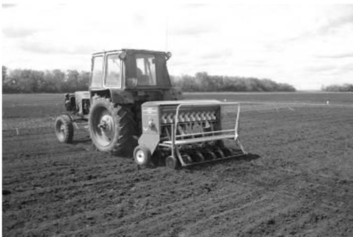
Рис. 1. Закладка опытов по экологическому сортоиспытанию селекционной сеялкой СС-11
