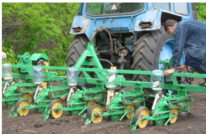
Рис. 1. Опытный посев амаранта на полях ГНУ Поволжский НИИСС имени П. Н.Константинова сеялкой с модернизированными секциями
