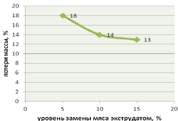
Рис. 4. Потери массы мясных рубленых изделий с растительным наполнителем при тепловой обработке
