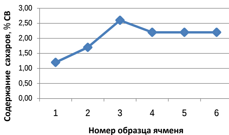
Рис. 3. Содержание водорастворимых сахаров в экструдате ячменя в зависимости от продолжительности экструзионной обработки
