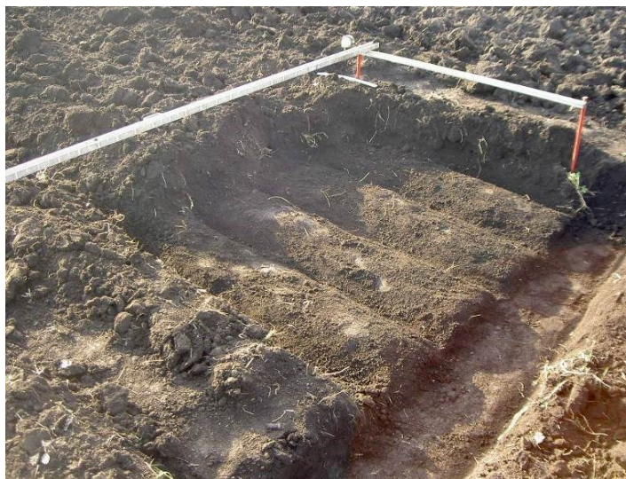
Рис. 4. Профилирование дна борозды
