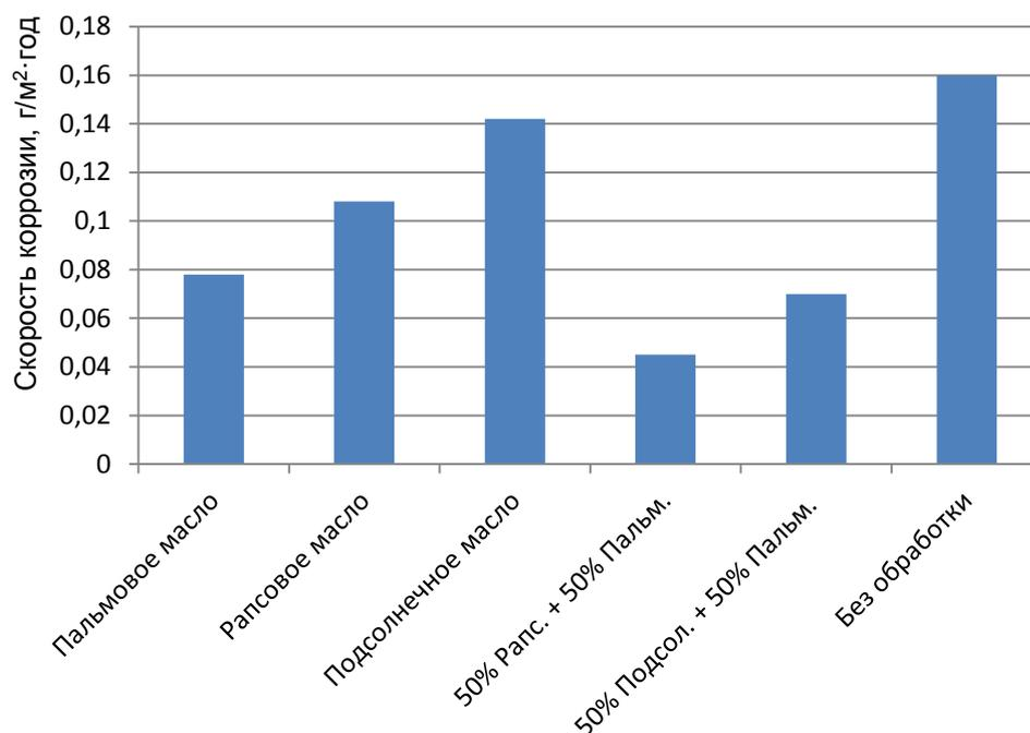
Рис. 1. Скорость коррозии при нанесении консервационных материалов
