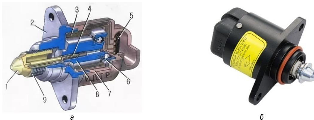
Рис. 1. Электродозатор смесителя:
