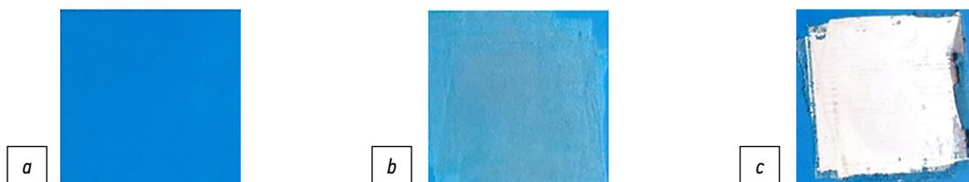
**Рис. 3.** Макроморфология участков (площадью по 4 см<sup>2</sup>) с лакокрасочного покрытия алкидного типа (со средней толщиной 120 мкм), сфотографированных до и после лазерной очистки в режимах с разными параметрами: *a* — поверхность лакокрасочного покрытия до лазерной очистки; *b* — частично очищенная поверхность после лазерной очистки в режиме 2 по табл. 2; *c* — полностью очищенная часть поверхности после лазерной очистки в режиме 4 по табл. 2.
